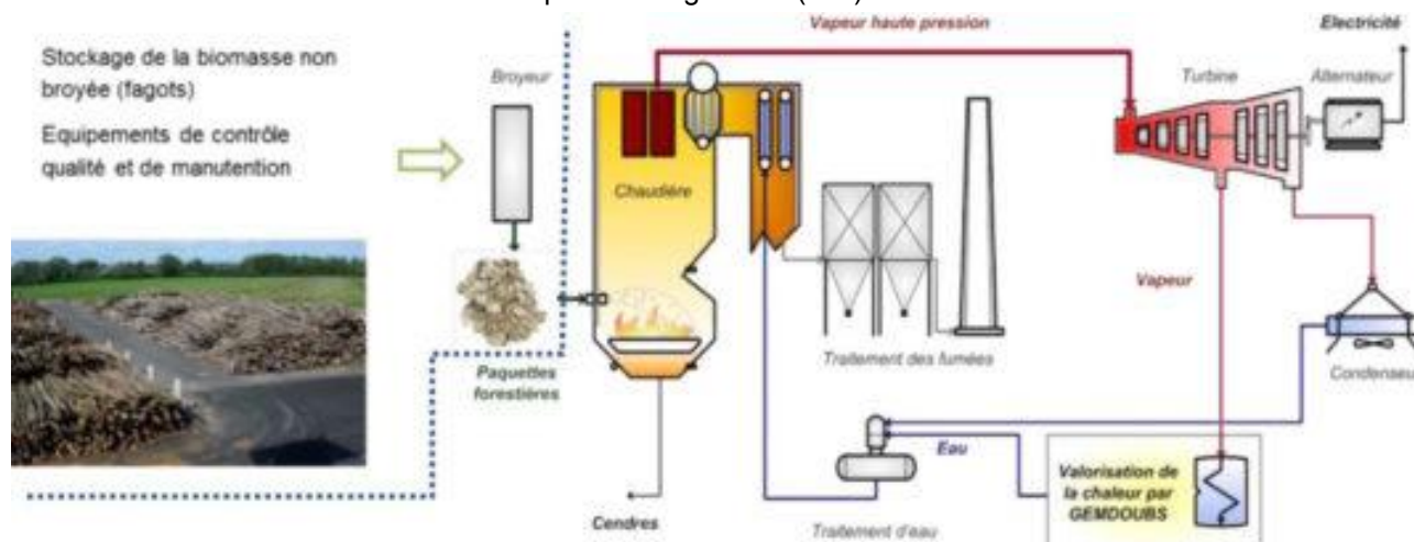
Schéma de fonctionnement de CBN. Cliquer sur l'image pour l'agrandir .
