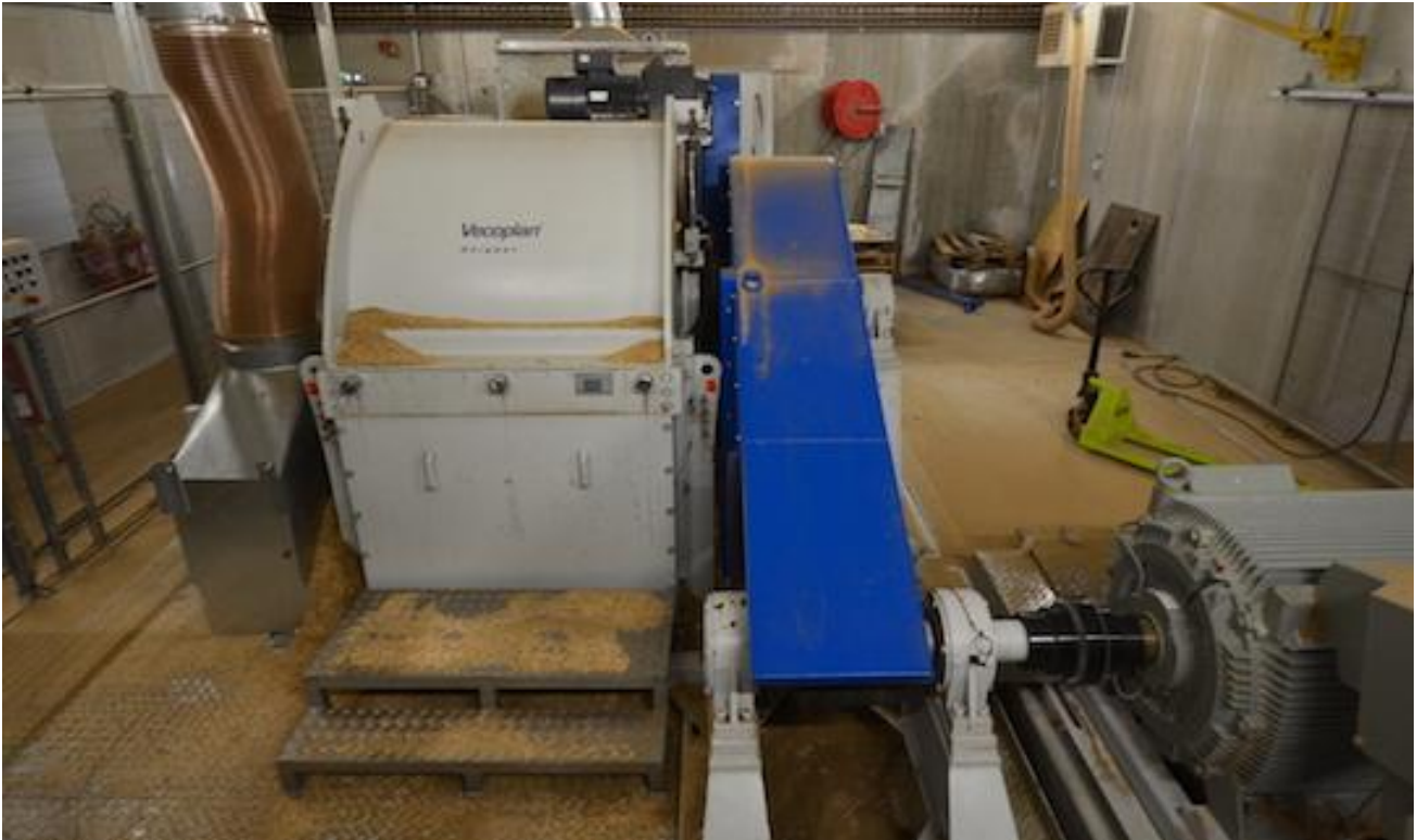
Le broyeur à couteaux VECOPLAN avec aspiration des poussières, photo Frédéric Douard
