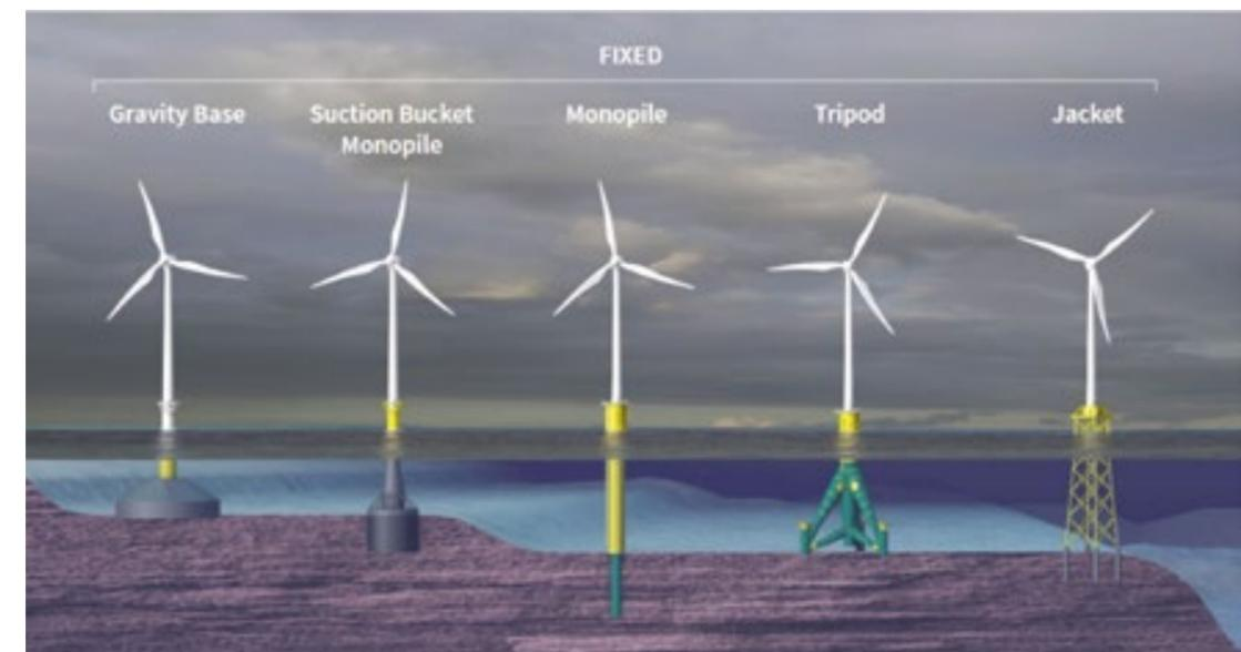
Figure 3. Éolien en mer posé : différents types de structures.
